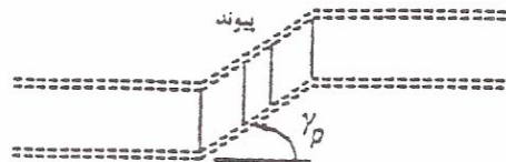
شکل (ت ۵-۴): زاویه‌ی چرخش تیر پیوند
