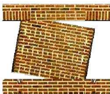
شکل ۱-۴-۱: ترک مورب در دیوار
